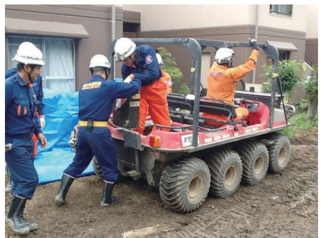
小型水陸両用バギーによる活動 （平成26年8月29日・広島市） （岡山市消防局提供）
